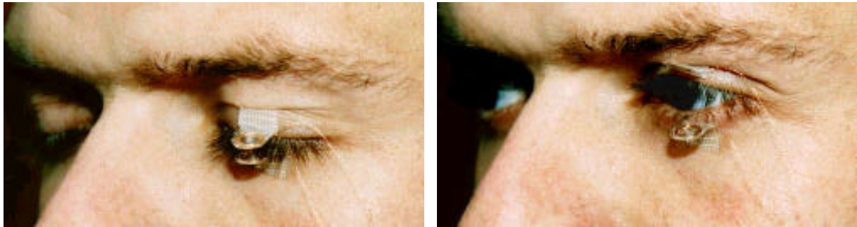
Bild 3: Proband mit Magnetspulen zur Erfassung des Lidschlusses und des Blickverhaltens. Eine der beiden Spulen ist am Oberlid, die andere am Unterlid befestigt.
