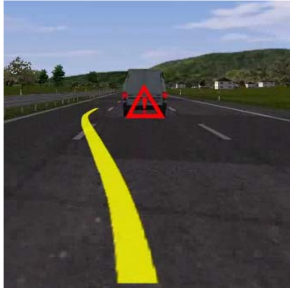
Bild 3: Zielkonzept, bestehend aus Kollisionsanzeige (rotes Warndreieck) und Ausweichanzeige (gelber Pfad)
