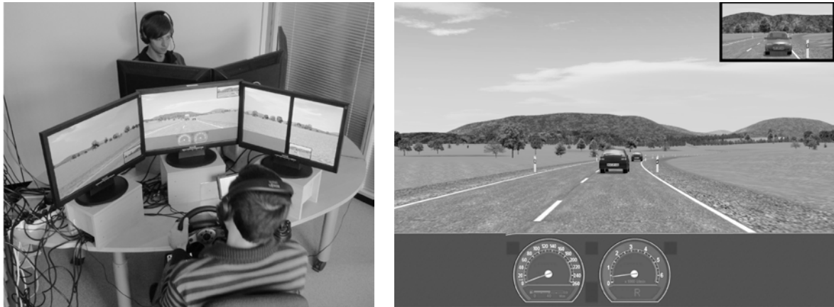
Abbildung 1: Fahrstationen der Pulksimulation (links). Screenshot aus Sicht des dritten Fahrers eines Pulks mit vier Fahrzeugen – zu sehen sind die Fahrzeuge der anderen drei Probanden des Pulks in der Frontsicht sowie im Innenspiegel (rechts).
