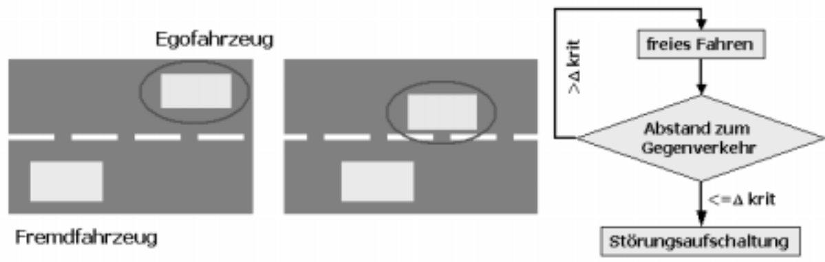
Abbildung 17: Auslösung einer Lenksystemstörung in Abhängigkeit von Verkehrssituationen
