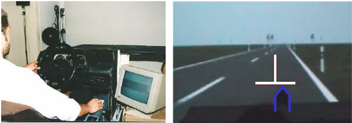
Bild 2: Fahrsimulator (links) und Trackingaufgabe (Screenshot; rechts).
